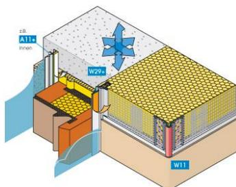
Profil mit integriertem Fugendichtband zur entkoppelten Herstellung von Anschlüssen
