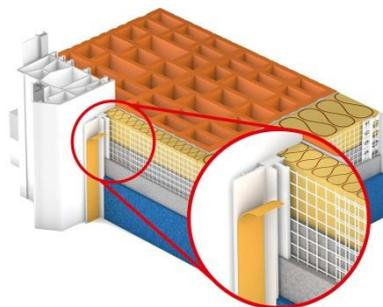
einteiliges Profil nur mit Fugendichtband als schlagregendichter Anschluss geeignet, für dünn-schichtige Putzsysteme, Breite 9 mm
