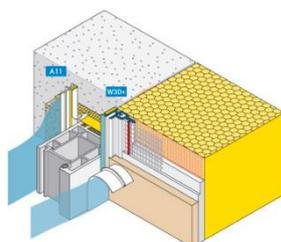
zweiteiliges horizontal und vertikal bewegliches Profil mit Gewebestreifen
