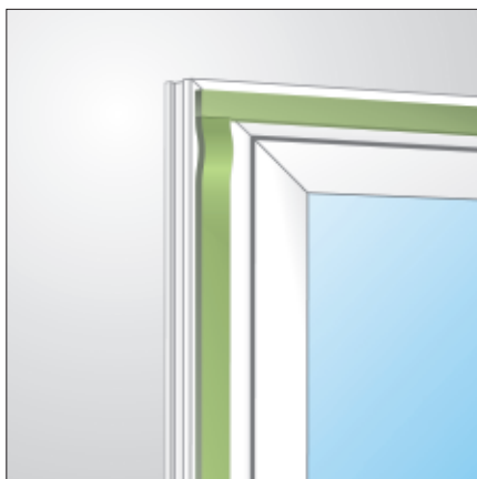
Bild 3: Bandverlegung bei der Fenstermontage
