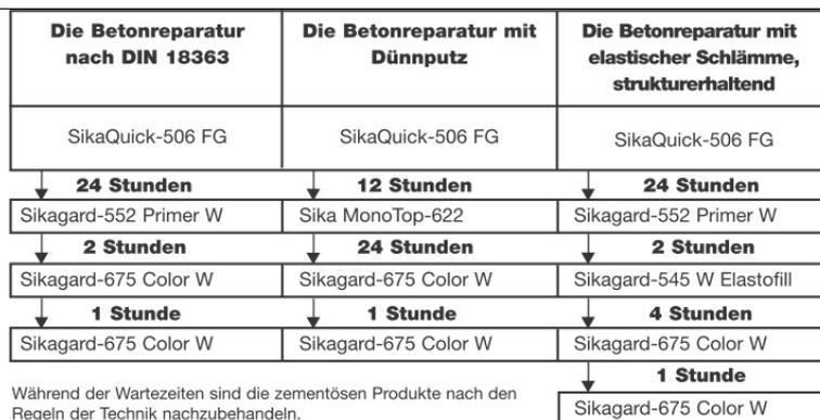
SikaQuick-506 FG ist grundsätzlich mit einem spannungsarmen Anstrich zu überarbeiten. Bei dichten Oberflächen muß mit Sikagard-551 S-Elastic Primer gearbeitet werden. Die Wartezeiten verlängern sich entsprechend. Bei Altanstrich gelten die jeweiligen Hinweise in den Produktdatenblättern!
